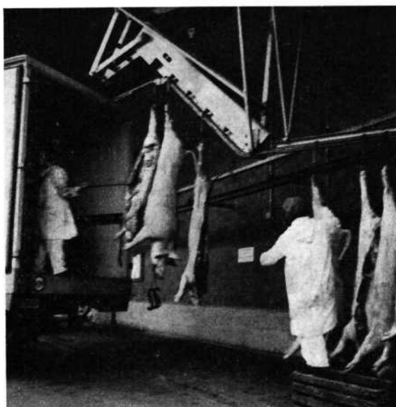
Rail élévateur pour le chargement des carcasses de porcs.
